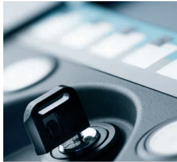
除了手輪和兩個指示燈按鈕之外，還有一個具鑰匙的切換開關可作附加的控制元件（選配）。
