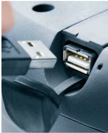
可與外部連接的 USB 接頭，是 SIMATIC Mobile panel 277 IWLAN 的標準配備。
